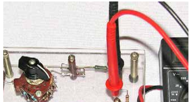
Рис. 2. Вигляд мініатюрної установки для виконання лабораторної роботи «Дослідження корисної потужності та к.к.д. джерела струму»
