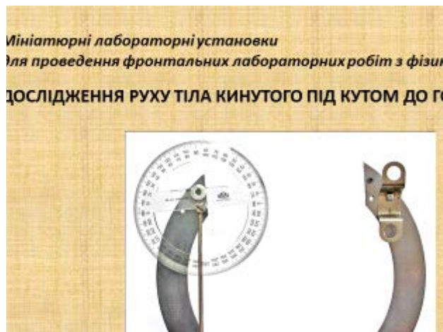
Рис. 4. Вигляд лабораторної установки для дослідження руху тіла під кутом до горизонту, що пропонується нами
